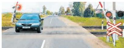
*Красный сигнал светофора не допускает движения через переезд независимо от положения шлагбаума и отсутствия поезда*
