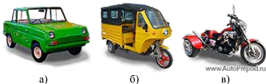
Рис. 3. Квадрициклы: а) – мотоколяска; б) – трицикл; в) – трехколесный мотоцикл.
